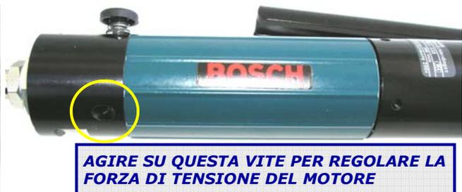
**LA VERSIONE A PULSANTE PERMETTE L'ALIMENTAZIONE SIMULTANEA DELLA PINZA PNEUMATICA CHIUDI SIGILLO TIPO "STP" E DEL TENDITORE**
