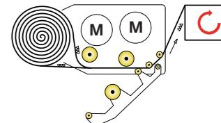
**IT** Sistema di prestiro motorizzato a 3 rulli comando elettronicamente con rapporti intercambiabili: 150 - 200 - 250%.
